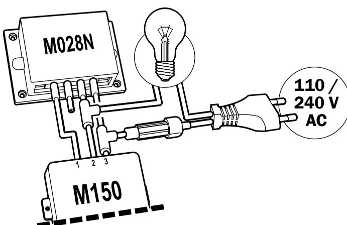
**max. 4000 VA | Max. Belastung:** 18 A bei Montage auf einen Kühlkörper | **Ohne zusätzlichen Kühlkörper:** max. 6 A (Spitze: max. 25 A / 10 Sek.) | **Regelung:** Phasenanschnitt | **Anschließbare Lasten:** ohmsche + induktive Lasten (siehe Schaltungsbeschreibung) | **Maße:** 87 x 60 x 33 mm
