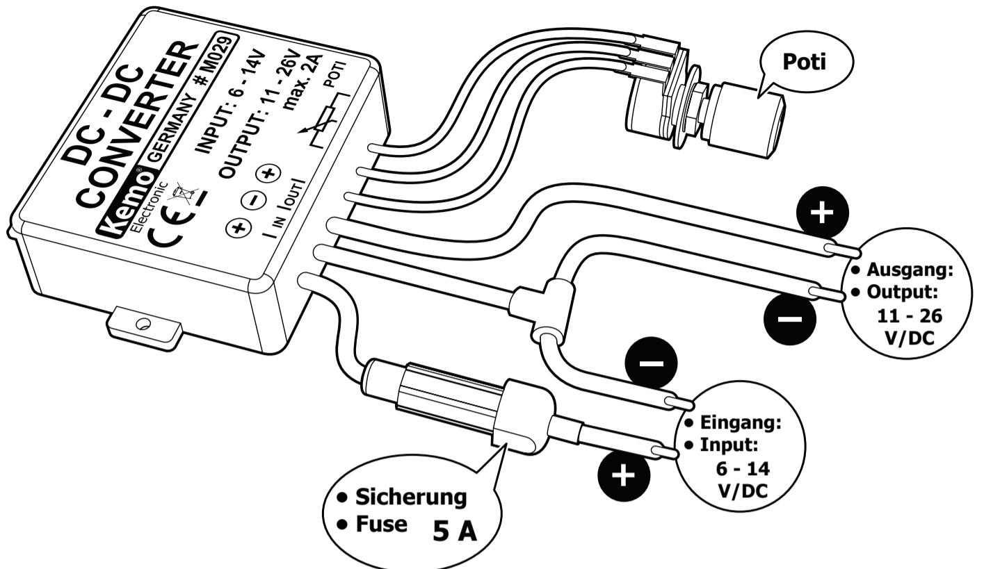
**Achtung:** Mit dem zusätzlichen Poti 4,7 k lin. kann die max. Ausgangsspannung je nach Belastung auf ca. 18 - 23 V begrenzt werden. Das Potentiometer wird nicht mitgeliefert!
