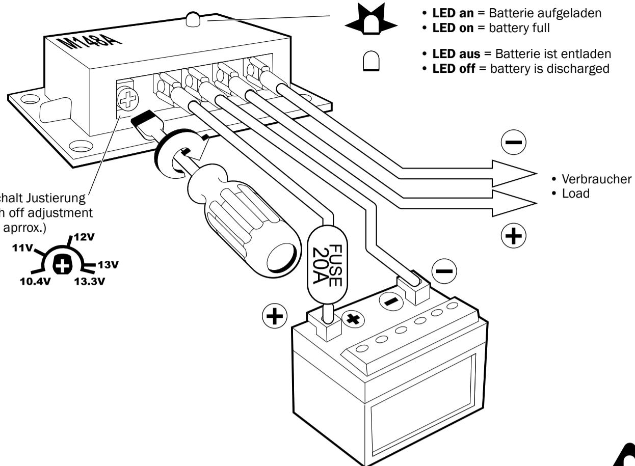
**DE | Wichtig!** Die Alu-Grundplatte darf keinen mechanischen Spannungen ausgesetzt werden (keine Löcher bohren, nicht auf unebene Kühlfläche schrauben usw.). Auf der Innenseite der Alu-Grundplatte sind direkt anliegend empfindliche elektronische Bauteile montiert, die bei mechanischen Bewegungen defekt werden und das Modul dann nicht mehr arbeiten!
