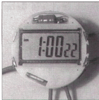
Bild 1: Das Uhrenmodul hat nicht einmal 30 mm Durchmesser; gemessen daran ist die Anzeige recht groß.
