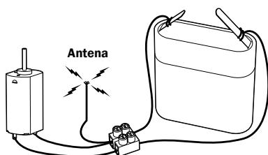
**Nadajnik radiowy w systemie Marconiego**
