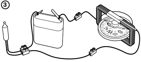
**Comprobación de corriente mediante una brújula**
