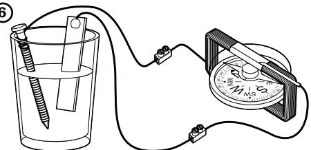
**Самодельно сконструированная батарея**
