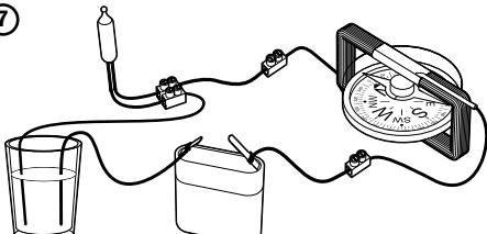
**Ensayo: Conductibilidad de agua**
