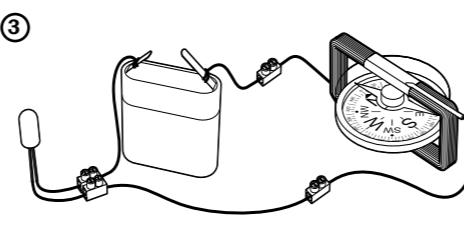
**Comprobación de corriente mediante una brújula**
