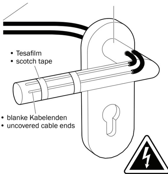
Vaikka lamppu ei vilku, se ei takaa jännitteettömyyttä! Voi edelleen syntyä voimakkaita jännitepulsseja, ne ovat vain alle 500 V.
