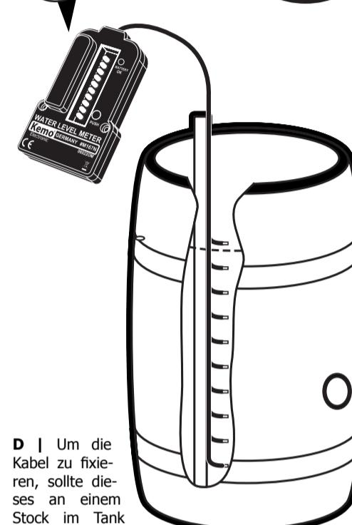
**D | Um die Kabel zu fixieren, sollte dieses an einem Stock im Tank befestigt werden. Die Enden müssen ca. 1 - 3 cm blank abisoliert sein.**
