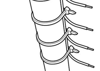
**DE |** Um die Kabel zu fixieren, sollte dieses an einem Stock im Tank befestigt werden. Die Enden müssen ca. 1 - 3 cm blank abisoliert sein.
