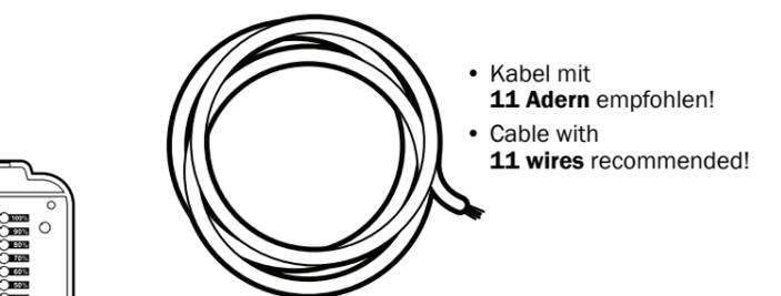
**DE | Hinweis!** Einige Geräte haben neben dem Masseanschluss noch einen zusätzlichen Erdungsanschluss. Dieser wird verwendet, wenn Sie abgeschirmtes Kabel verwenden (zum Erden der Abschirmung). Das ist nur erforderlich, wenn starke elektromagnetische Störungen das Messergebnis stören.
