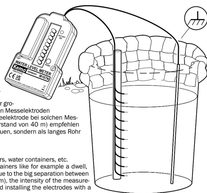
**tank: 1 - 10, umschaltbar | Stromaufnahme während der Messung (Taste gedrückt):** max. 120 mA, wenn alle LED's leuchten | **Max. Kabellänge zwischen Füllstandsmelder und Wassertank:** 100 m | **Erforderliches Kabel zum Wassertank:** mindestens 11 Adern Telefonkabel oder ähnliches Kabel | **Messstrom am Wassertankfühler:** ca. 50 µA pro Kanal | **Maße:** ca. 131 x 78 x 36 mm
