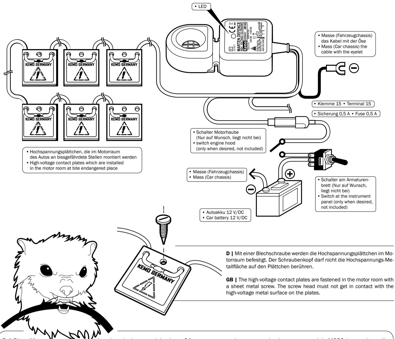
D | Mit einer Blechschaube werden die Hochspannungsplättchen im Motorraum befestigt. Der Schraubenkopf darf nicht die Hochspannungs-Metallfläche auf den Plättchen berühren.
