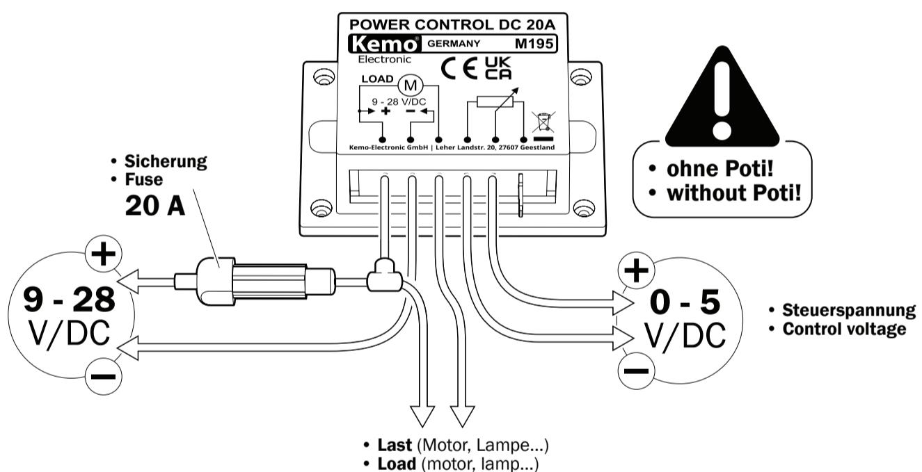
**DE | Wichtig!** Die Alu-Grundplatte darf keinen mechanischen Spannungen ausgesetzt werden (keine Löcher bohren, nicht auf unebene Kühlfläche schrauben usw.). Auf der Innenseite der Alu-Grundplatte sind direkt anliegend empfindliche elektronische Bauteile montiert, die bei mechanischen Bewegungen defekt werden und das Modul dann nicht mehr arbeitet!
