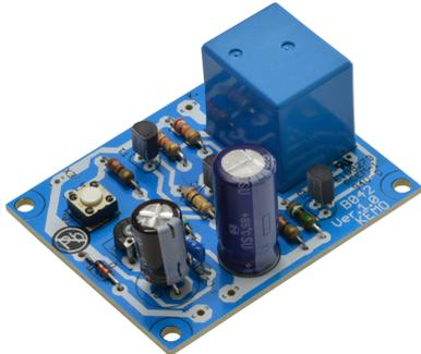
Nach Tastendruck schaltet das eingebaute Relais für ca. 2 Sekunden bis ca. 5 Minuten (justierbar) ein und dann wieder aus.
