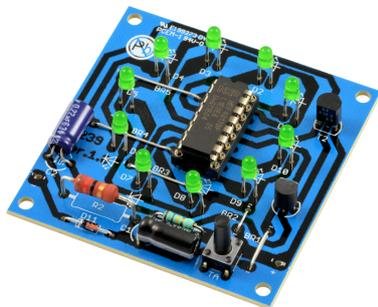
Nach dem Loslassen des Tastschalters läuft das Lichtsignal an den 10 LEDs schnell im Kreis herum, wird langsamer und stoppt dann zufallsbedingt an einer der LEDs. Während des Betriebs leuchten alle LEDs, außer der LED, die gerade das Signal bekommt. Dadurch sieht die leuchtende Platine sehr dekorativ aus.
