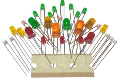
Verschiedene Typen von LEDs Bei den LEDs in dieser Tüte handelt es sich um Standard-LEDs in verschiedenen Farben und Formen. Alle LEDs werden mit einem Strom von 10 mA oder weniger betrieben. Jede LED muss mit einem Vorwiderstand betrieben werden, der je nach Betriebsspannung den Strom auf 10 mA oder weniger begrenzt. Die LEDs können mit Gleichspannung betrieben werden.
