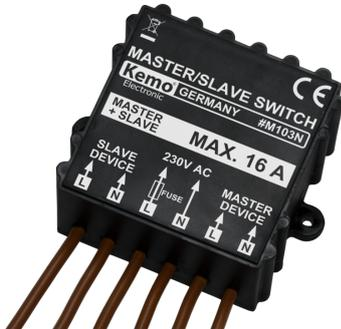
Schaltet automatisch beim Einschalten einer Maschine, Lampe usw. eine andere Last ein. Es können 1-phasige oder 3-phasige (Drehstrom-) Maschinen überwacht werden (dabei wird eine Phase abgetastet). Ausgangsseitig können 1-phasige Geräte (z.B. Staubsauger) automatisch eingeschaltet werden (oder Drehstromverbraucher über ein Hilfsrelais, liegt nicht bei). Max. je 15 A, max. Gesamtleistung: 3600 W.
