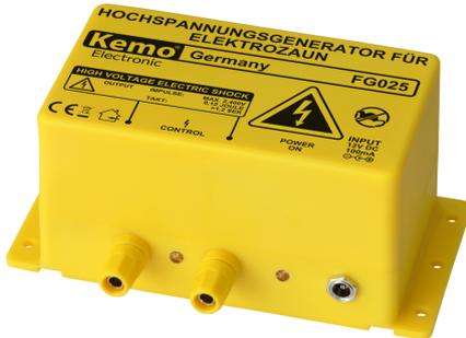
Elektrozaungerät für die Kleintierabwehr (Marder, Hunde usw.). Für Zaunlängen bis ca. 1 km (ohne Bewuchs). Hochspannungsimpulse: max. 2400 V im Takt >1,2 Sek. Extrem niedriger Stromverbrauch:  $\emptyset$  0,008 A. Zum Betrieb ist noch ein Steckernetzteil 12 V/DC, Leistung mind. 100 mA oder ein 12 V Autoakku >12 Ah erforderlich (beides liegt nicht bei). In beiden Fällen benötigt das Stromkabel einen Hohlstecker 5,5 x 2,1 mm.
