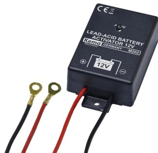
Arbeitet gegen die Ablagerung von Bleisulfat und erhöht damit die Lebensdauer des Autoakkus. Durch heftige, sehr kurze Stromimpulse wird aktiv Bleisulfat abgebaut bzw. die Ablagerung verhindert. Mit LED-Anzeige.
