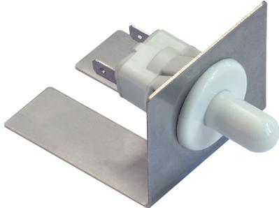
Den Schalter bitte so einbauen, das der Stift bei geschlossener Motorhaube ca. zu 60 - 80% eingedrückt ist. Dann schaltet die angeschlossene Marderscheuche ein. Der Stift darf nicht bis zum Anschlag eingedrückt werden, weil dann der Schalter defekt werden kann, wenn die Motorhaube kräftig zugeschlagen wird (der Stift schlägt dann gegen den Anschlag drückt das Schalter-Unterteil raus).
