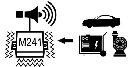
Vibrationsschalter, schaltet 12 V-Geräte bei Vibrationen (z.B. Motor-Laufgeräuschen) aus und bei Stillstand zeitverzögert ein. Betriebsspannung: 11 - 15 V. Für Geräte bis zu einer Stromaufnahme von ca. 1000 mA. Anzeige über eine blinkende LED. Der Vibrationsschalter schaltet z.B. Signalhörner ein, wenn eine Maschine (z.B. Pumpe) ausgeht und nicht mehr vibriert. Oder eine Marderscheuche, wenn das Fahrzeug keine Motorvibrationen oder Fahrerschütterungen mehr hat und parkt.
