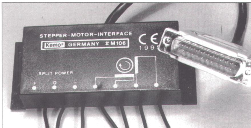
**Bild 5:** Das komplett vergossene Interface ist recht robust ausgeführt; es verträgt sogar eine zeitlang Überlast.
