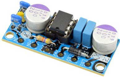
Este pequeño amplificador universal tiene una potencia musical de punta de 2 W. Un amplificador moderno, económico para muchos fines. El amplificador funciona con un DIP-IC de 8 polos de forma que este amplificador se pueda integrar en muchos aparatos.
