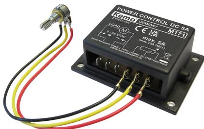
Regulador de potencia para reglar cargas de tensión continua (motores, lámparas, calefacciones, LEDs con resistores protectores, etc.). Los motores eléctricos arrancan bien también a un bajo número de revoluciones por el mando PWM (duración de impulsos) empleado.
