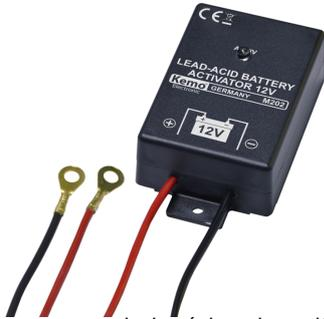
Actúa contra el depósito de sulfato de plomo y prolonga de esta manera la durabilidad del acumulador de coche. Se descompone activamente el sulfato de plomo y se impide el depósito respectivamente por impulsos de corriente intensos y muy breves. Con indicación LED.
