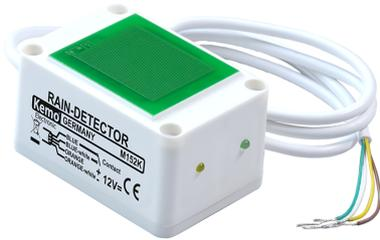
Cuando la placa completamente aislada del sensor se humedece (por ejemplo, gotas de lluvia), se enciende un relé. A diferencia de los detectores de lluvia con sensor de metal, este sensor funciona capacitivamente. Eso significa que también activa cuando tiene contacto con agua destilada (en caso de lluvia completamente limpia). Con esto se puede cerrar ventanas claraboya, retraer toldos o solo informa que hay lluvia. 2 LEDs incorporados indican la función. La sensibilidad es ajustable.
