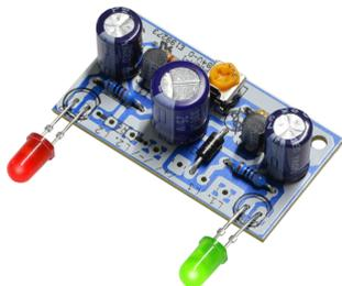
Прерыватель света / переменный прерыватель света (набор компонентов).
