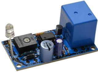
включает реле при изменении освещения. Применение: если свет лампочки прикрепленной над дверью, окне и т.д. будет прерван проходящим мимо человеком, включается реле. Данный прибор можно применить и в качестве ночного выключателя.
