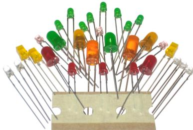
Если индикатор находится в этом пакете является стандартным. Светодиоды разных цветов и форм. Все светодиоды с током 10 мА или даже меньше. Каждый светодиод может работать с резистором, в зависимости от рабочего напряжения ток до 10 мА или меньше. Светодиоды могут работать с напряжением постоянного тока: К тому же, чем длиннее провода светодиода. На рисунке некоторые соединения приведены с резистором. Светодиоды интерпретировали по-разному в различных напряжениях цветового режима.
