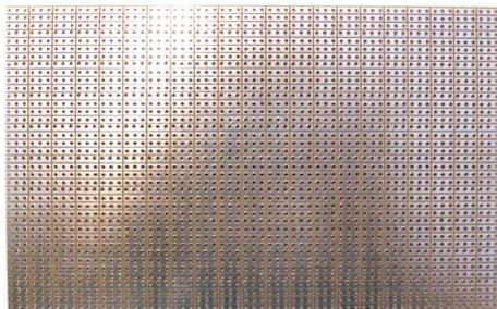
Полосы сетки прерываются через каждые 3 отверстия. Односторонний слой меди, позолоченная (что лучше для пайки со "свинцовым припоем"). FR2 прессованная бумага
