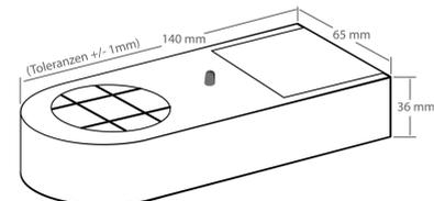
Громкоговоритель (Дополнение) на \$ M175, для того чтобы расширить эффективный диапазон акустической значительности. Необходимо для подключения 2-жильный кабель (макс. 50 м, по 0,5 мм<sup>2</sup>). Громкоговоритель должен быть установлен в водонепроницаемом месте (например, под крышей навеса). Имеется светодиодный индикатор.
