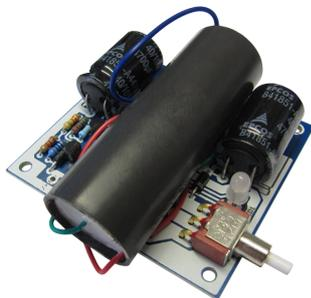
Вырабатывает из 9 В батарейки искры напряжением более 15.000 Вольт, которые могут пробить даже через ткань. Идеальная защита от диких животных и т.д., или использование для физических экспериментов. Владение прибором как оружием, запрещено во многих странах (например ЕС). Отпугивающий эффект уже достигается при виде искры и хлопков высоковольтного разряда!
