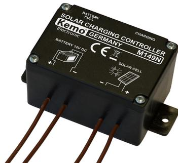
Данный солнечный регулятор зарядки подключается между солнечной батареей с постоянным напряжением 12 Вольт (напряжение холостого хода 14 - 30 Вольт) и 12 Вольтным аккумулятором с целью предотвратить перезарядку аккумулятора. Светодиодные показатели: «Аккумулятор заряжен» (BATTERY FULL) (приблизительно 14,4 Вольт) и «Идет зарядка» (CHARGING).
