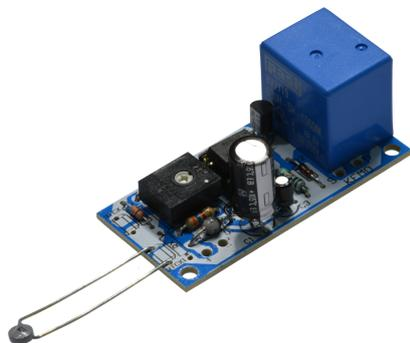
Включает или выключает реле соответственно настроенной температуре. Идеально применяется в виде термостата, пожарной сигнализации, опасности замерзания и т.д.
